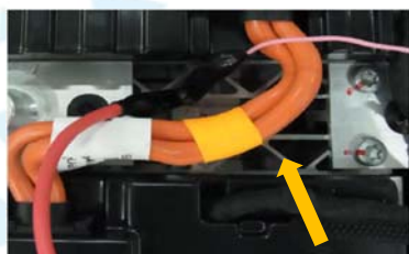
高压电缆的颜色
